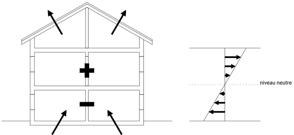
Schéma des conditions naturelles de pression dans une habitation (dépression au rez et évacuation à l'étage à cause du tirage thermique naturel)
