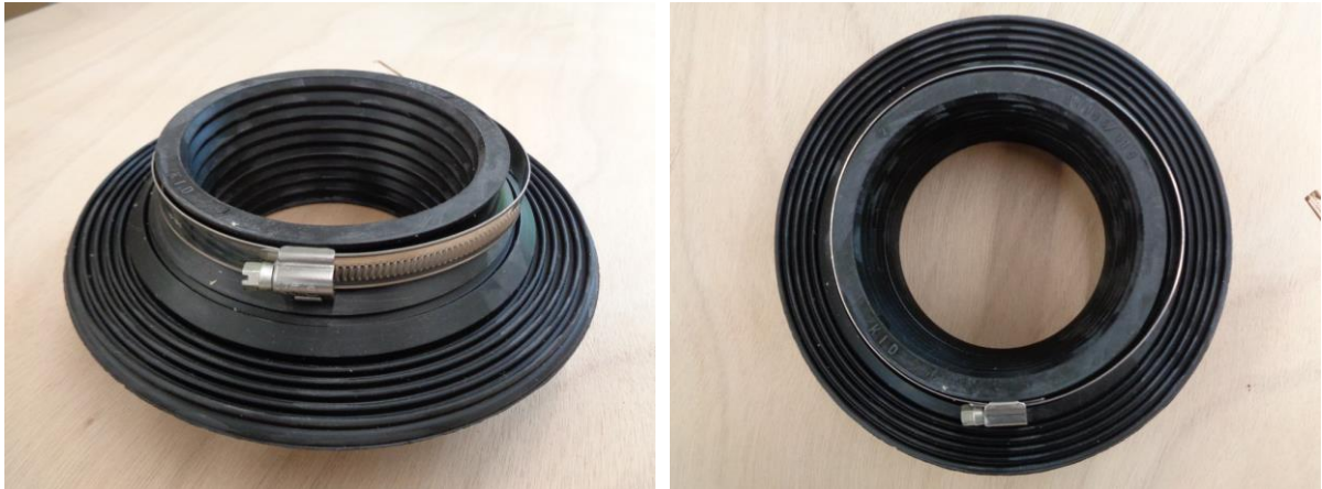
Joint « Frank » avec collier de serrage pour passage de conduites verticales à travers un radier neuf (photo : ©Effiteam Sàrl). Ces joints sont à poser sur les tubes avant le coulage de la dalle béton.
