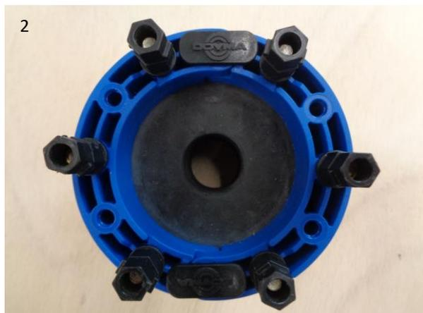
**1 et 2** : Fourreau étanche pour passage de conduites à travers murs et radier (photo : ©Effiteam Sàrl). A poser uniquement après le bétonnage. Un forage est nécessaire pour insérer le fourreau sur la conduite posée après le coulage du béton. Une fois le fourreau en place, les vis avec tête en plastique doivent être serrées dans l'ordre prescrit et jusqu'à leur rupture (afin d'atteindre le couple de serrage calculé par le fabricant) pour assurer l'étanchéité.
